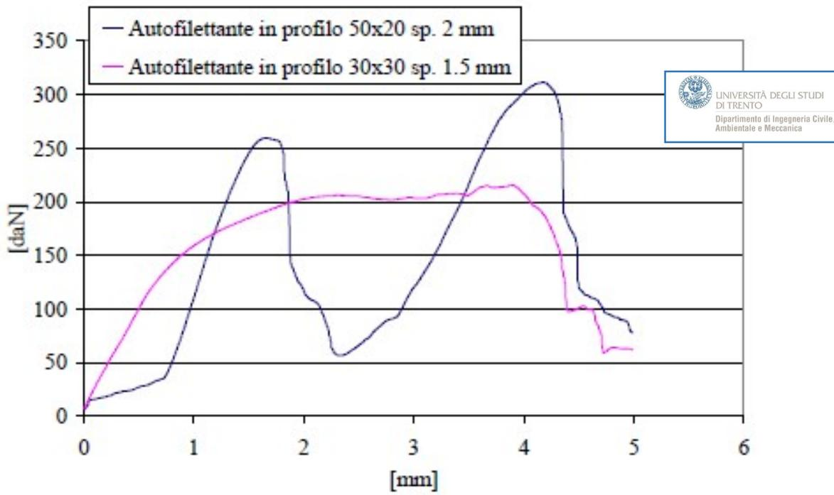
Valore medio di resistenza a trazione per singola vite con preforo diametro  $\varnothing$  3,0mm:
