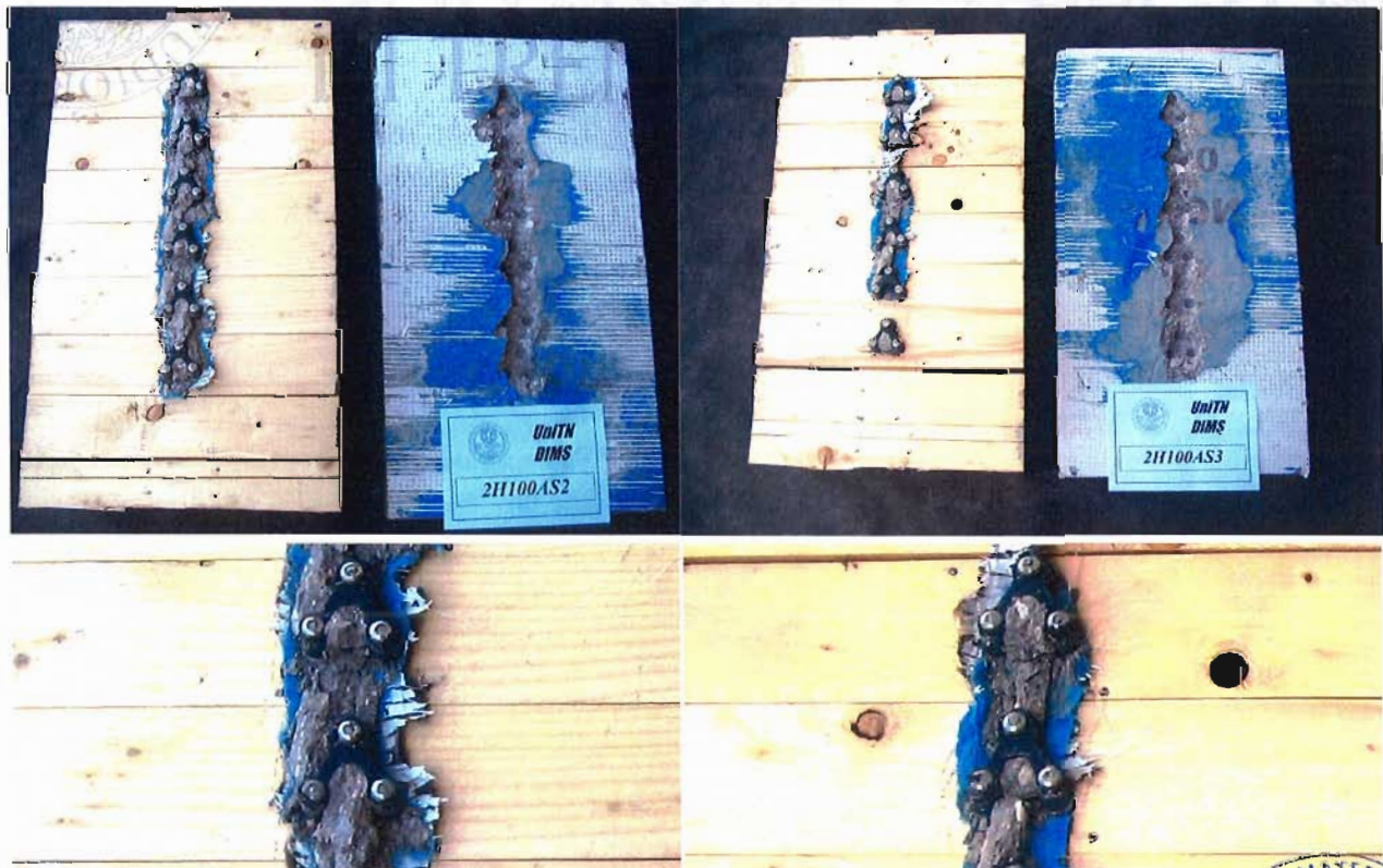
Figura 8 - Modalità di rottura di provini tipo 2H 100AS.
